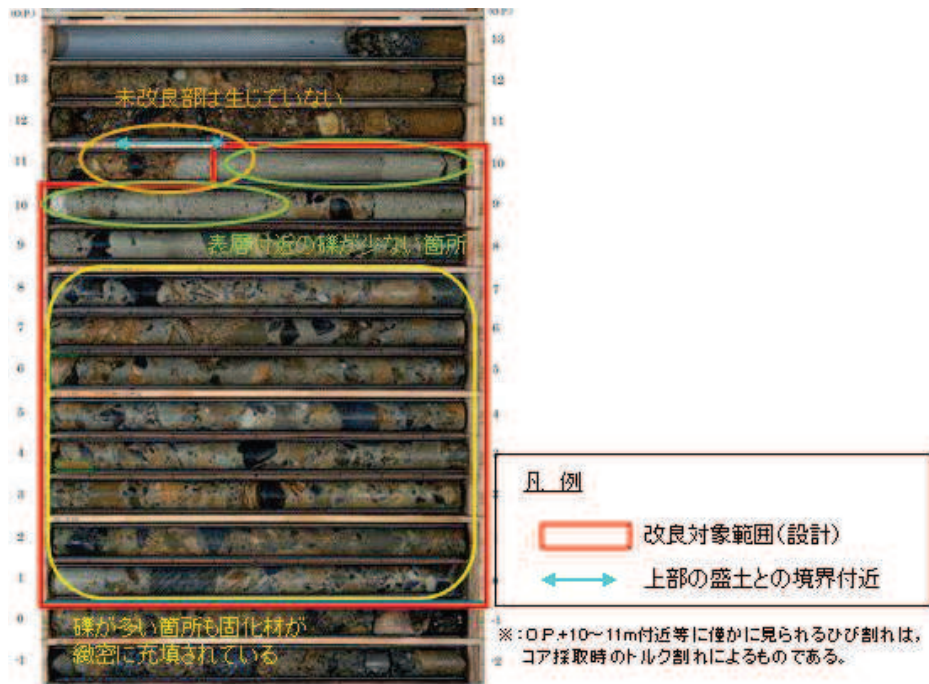
図 6.4-13 ボーリングコア写真 (④孔)
