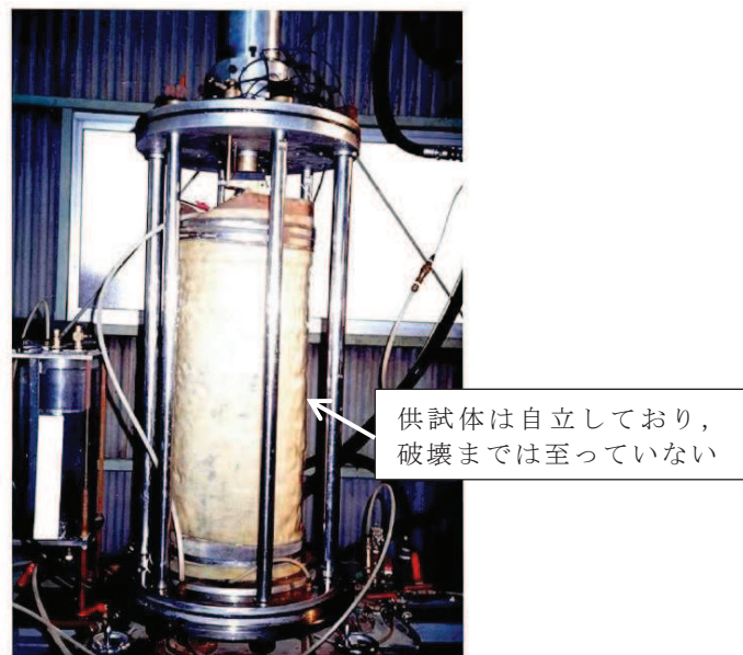
図 3-3 動的変形試験終了後の供試体
