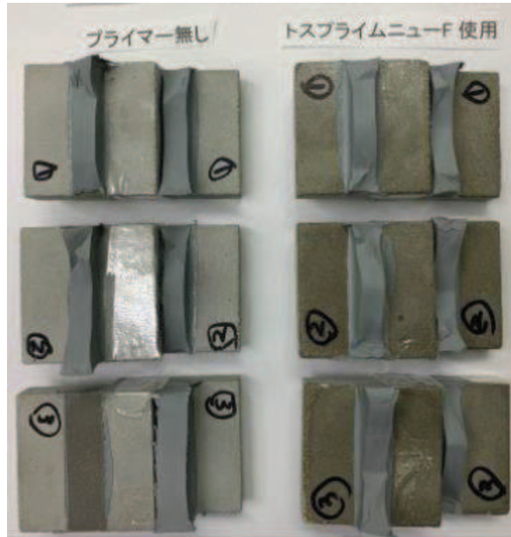
写真1 接着性（付着性）試験結果
