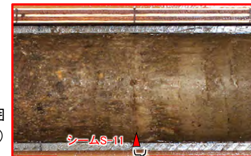
6.40m~6.41m: 細粒凝灰岩が分布する。
