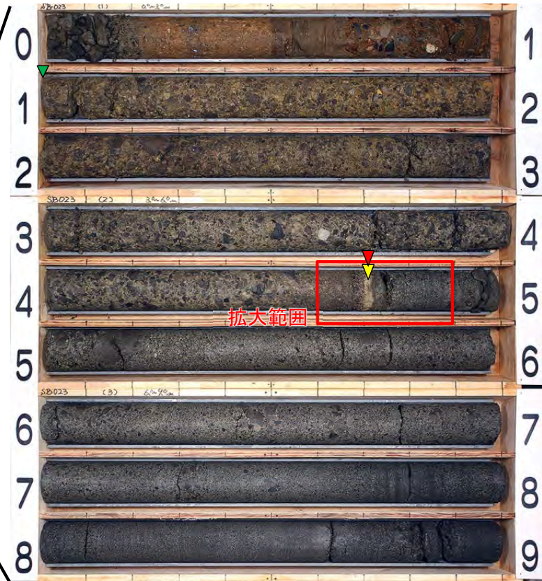
SB-023孔 コア写真(深度0m~9m) ▼ 岩盤上面 ▼ 風化部下限(弱風化部下限) ▼ シームS-11
