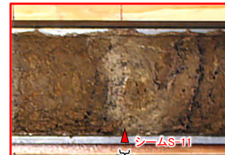
3.80m~3.81m: 細粒凝灰岩が分布する。
