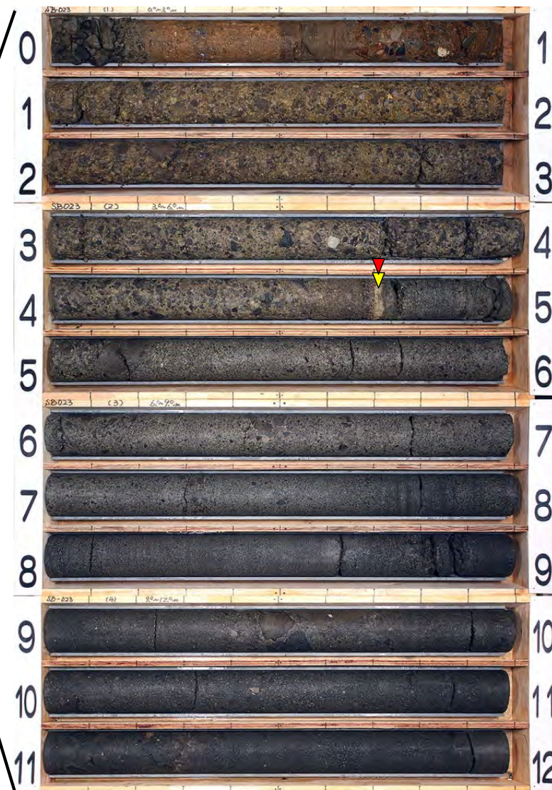
SB-023孔 コア写真(深度0m~12m)
