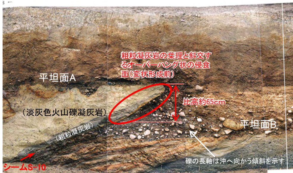
写真2 Ts-1西側法面に見られるオーバーハング状の侵食面(P.4-29参照)
