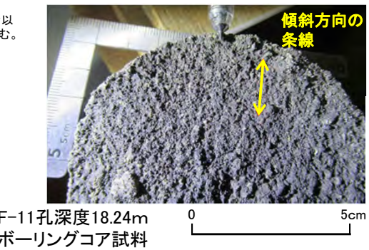
低角の変位を伴う不連続面 ・新鮮部 ・面の傾斜角: 30° ・傾斜方向のやや不明瞭な条線 (プランジ角約30°)
