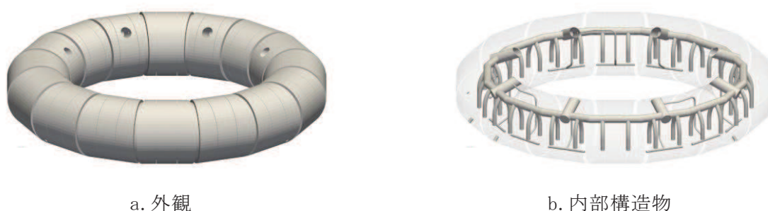
図24 流体解析に用いる実機解析モデル
