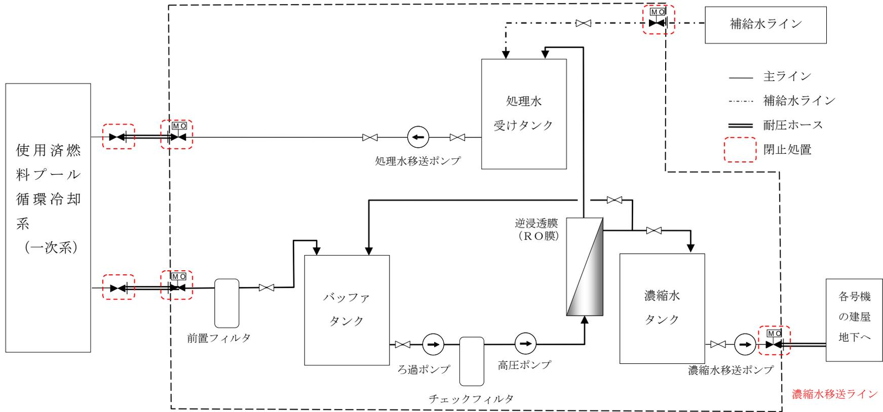
図2 モバイル式処理装置 (塩分除去装置 (RO膜装置)) 切り離し状態図
