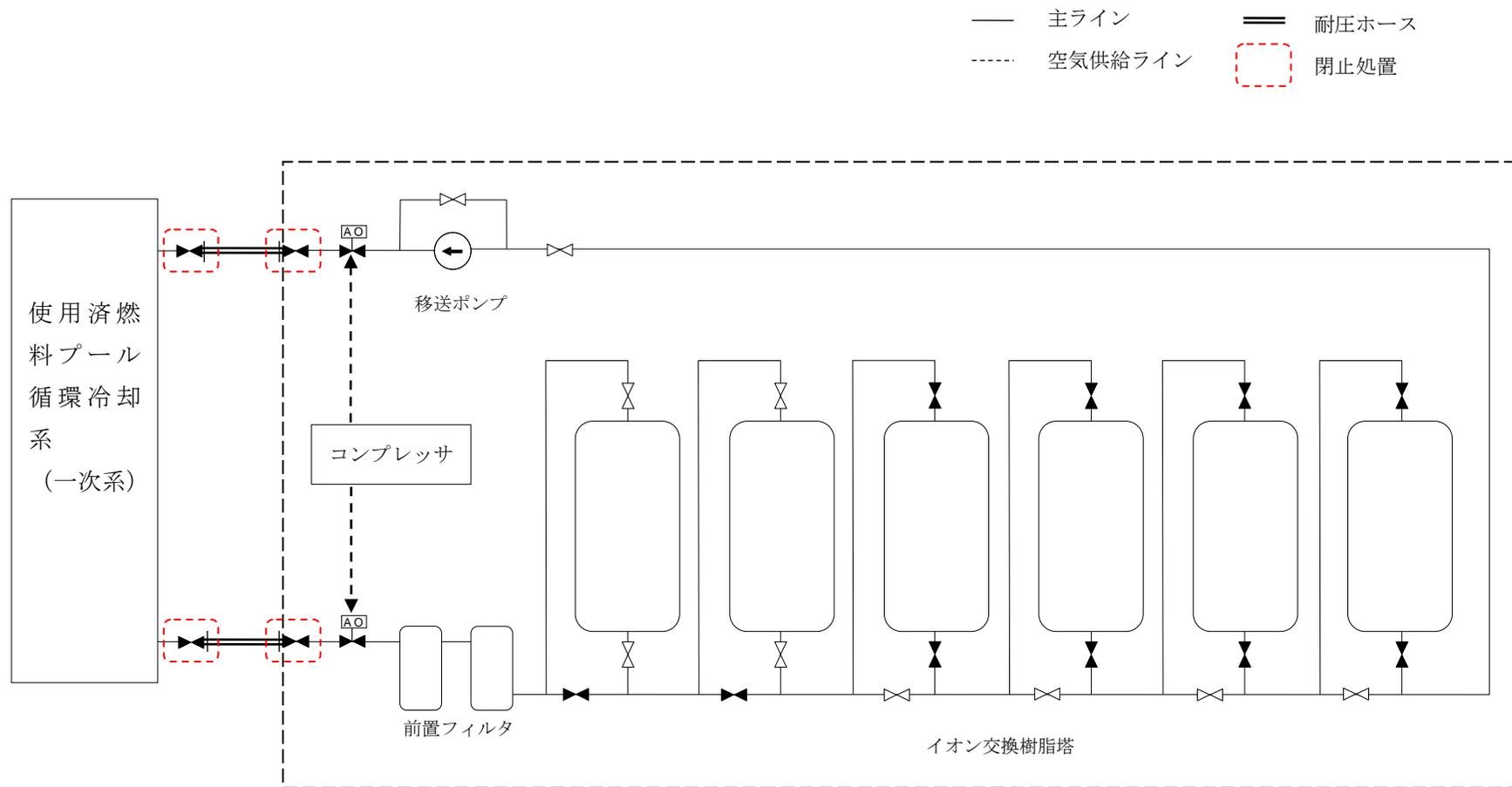
図3 モバイル式処理装置（塩分除去装置（イオン交換装置））切り離し状態図
