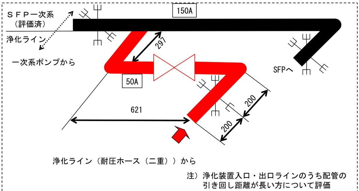
図-3 浄化ラインヘッド部概要図 (4号機)
