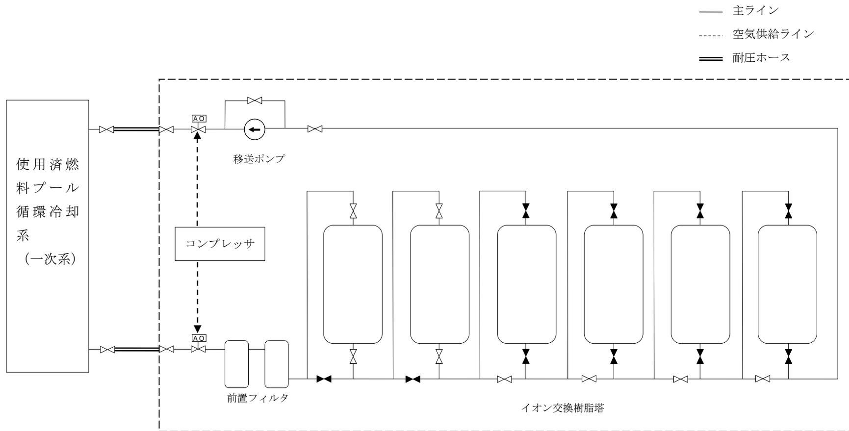
図-5 モバイル式処理装置 (塩分除去装置 (イオン交換装置)) 系統概略図
