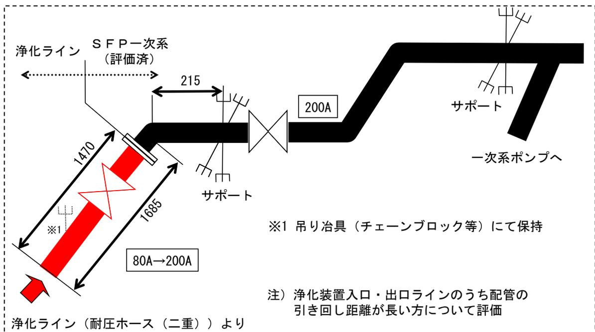
図-1 浄化ラインヘッド部概要図（2号機）
