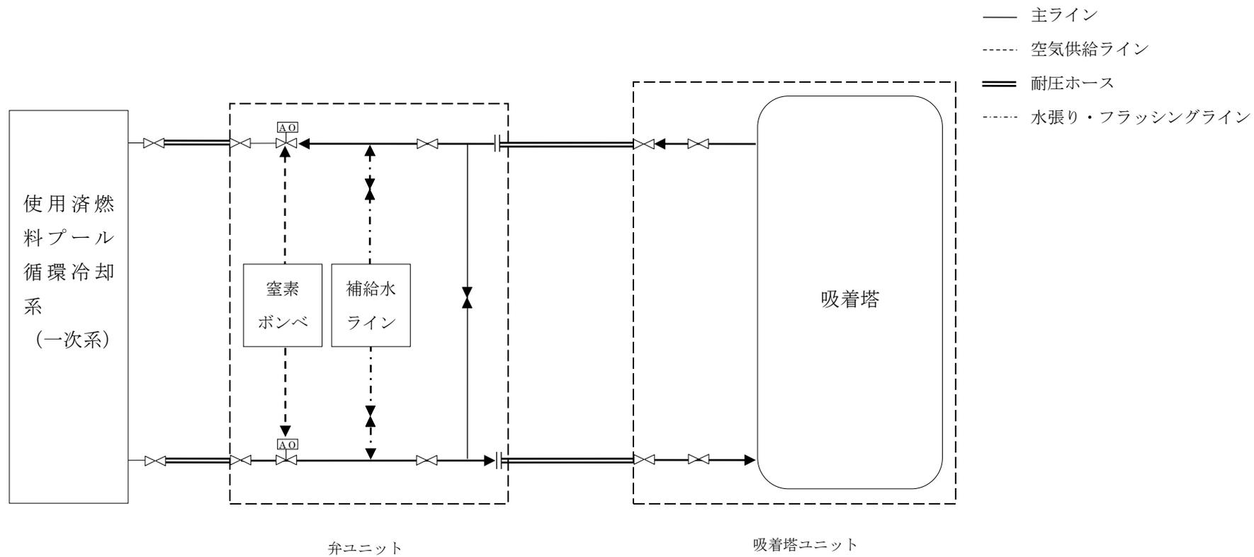
図-3 放射能除去装置系統概略図
