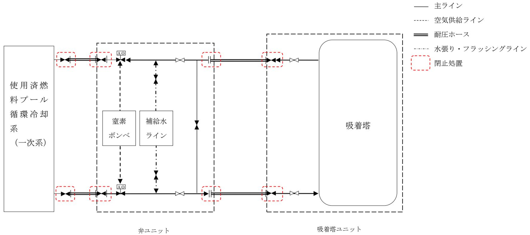
図1 モバイル式処理装置 (放射能除去装置) 切り離し状態図
