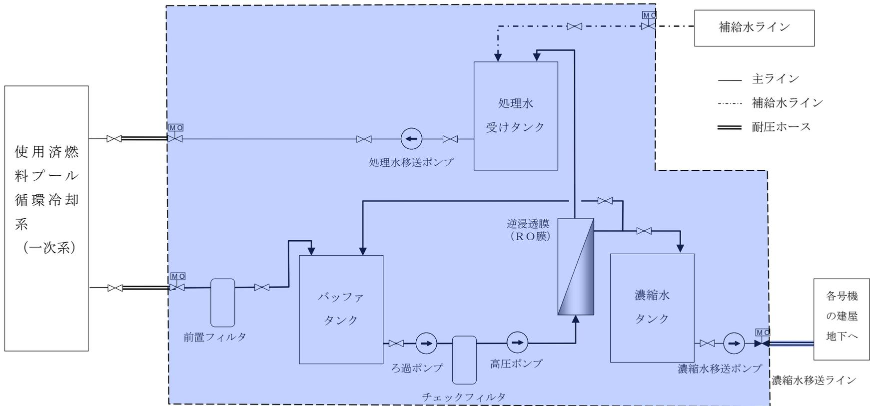
図 11 申請範囲 (モバイル式処理装置 (塩分除去装置 (RO 膜装置))) ※ 3, 4 号機接続時
