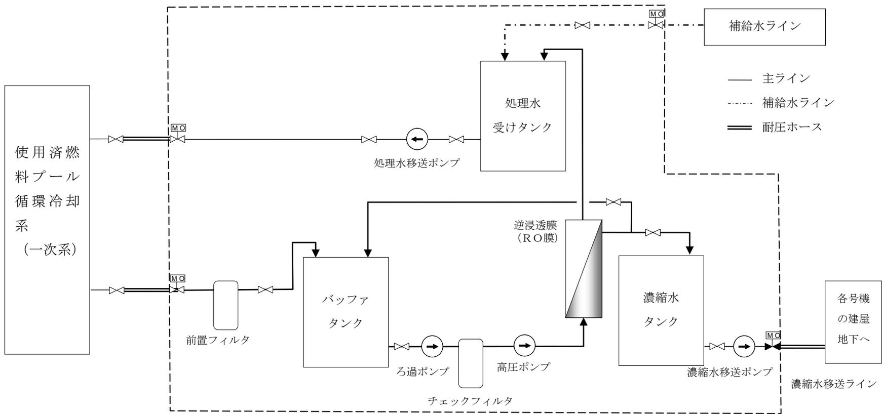
図-4 モバイル式処理装置（塩分除去装置（RO膜装置））系統概略図
