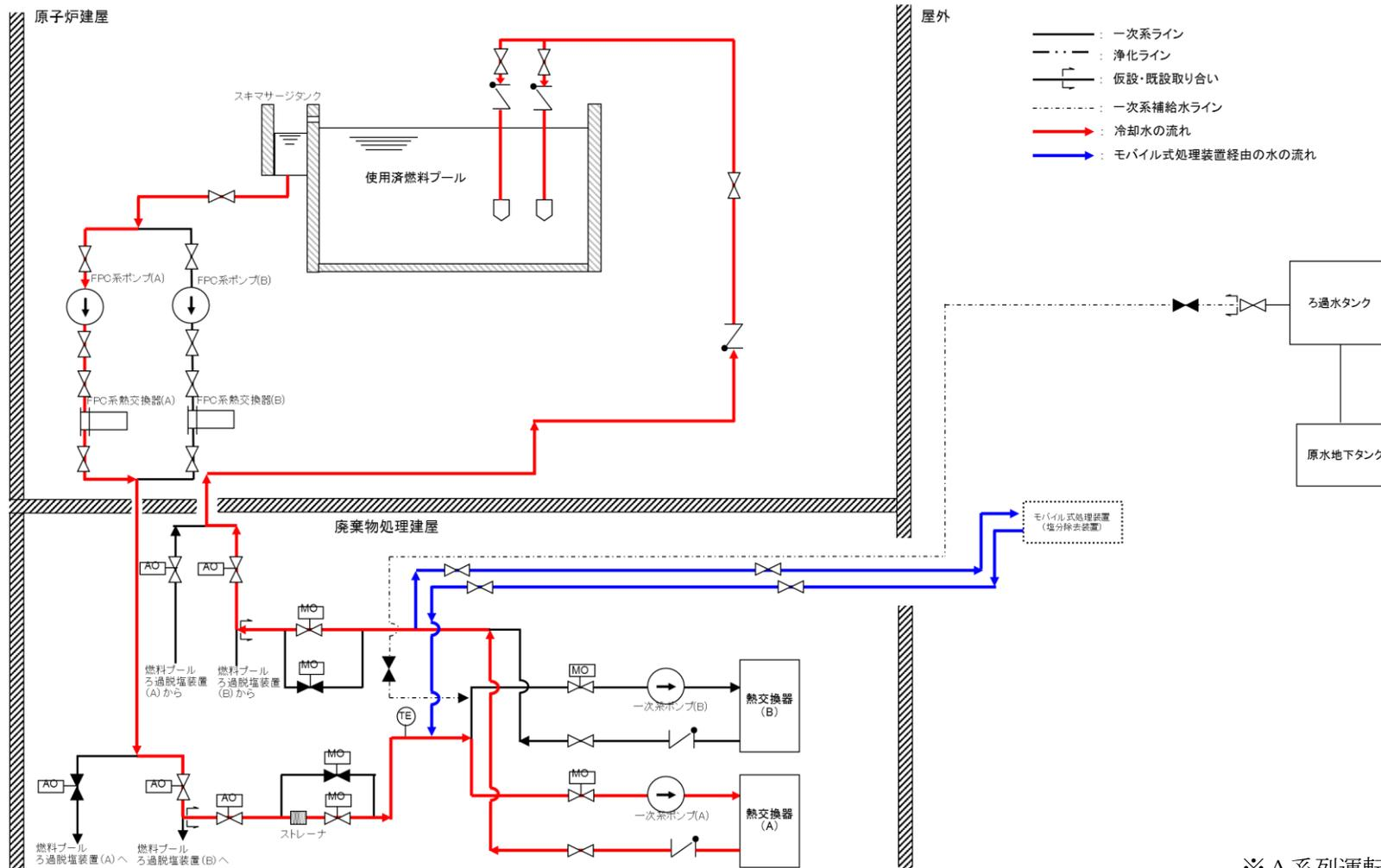
図 3 3号機使用済燃料プール循環系系統概略図 (モバイル式処理装置運転中)
