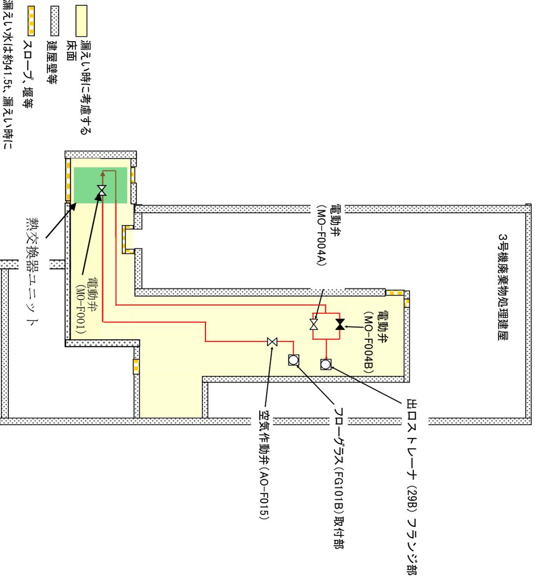
※漏えい水は約41.5t、漏えい時に考慮する床面積約418m<sup>2</sup>から漏えい時の3号機廃棄物処理建屋における漏えい水高さは約10cmとなる。電動弁、空気作動弁はこれより高い位置に設置されており、漏えい水が弁の作動に影響を与えることはないと考えられる。
