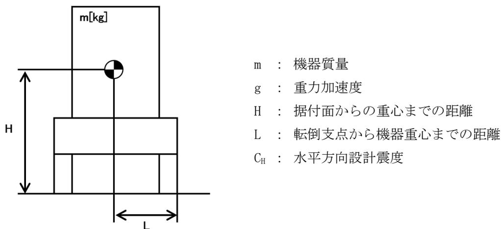
地震による転倒モーメント :  $M_1 [N \cdot m] = m \times g \times C_H \times H$
