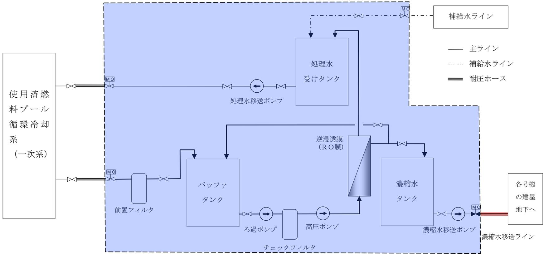
図 10 申請範囲 (モバイル式処理装置 (塩分除去装置 (RO 膜装置))) ※ 1, 2 号接続時
