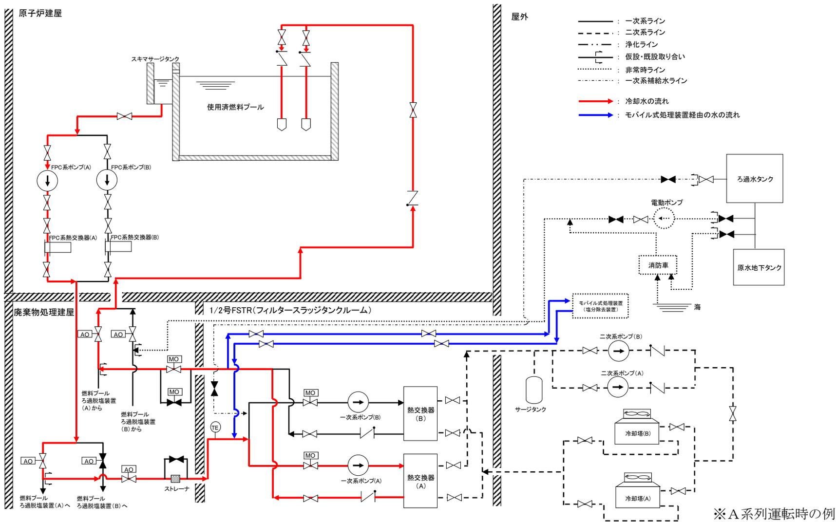
図 2 2号機使用済燃料プール冷却系統概略図 (モバイル式処理装置運転中)
