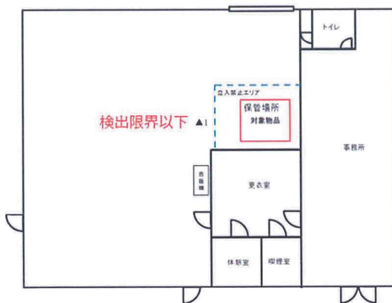
図6 廃材保管場所周辺の空气中放射能濃度測定
