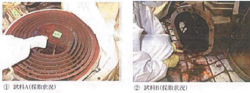
図7 廃材付着物の核種分析サンプル採取状況
