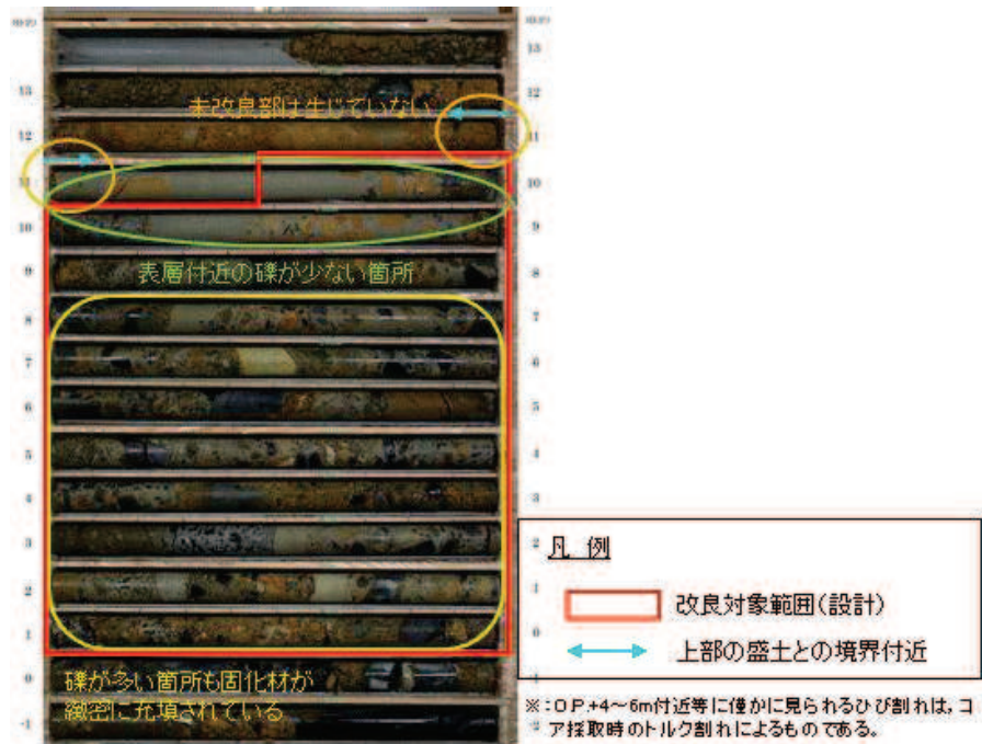
図 6.4-14 ボーリングコア写真 (⑤孔)
