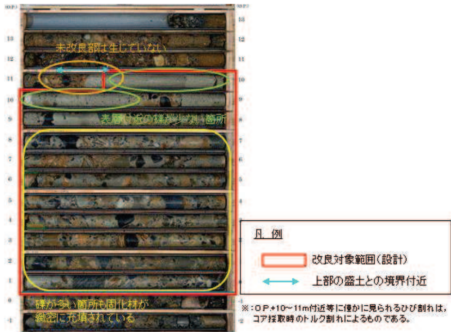
図 6.4-13 ボーリングコア写真 (④孔)
