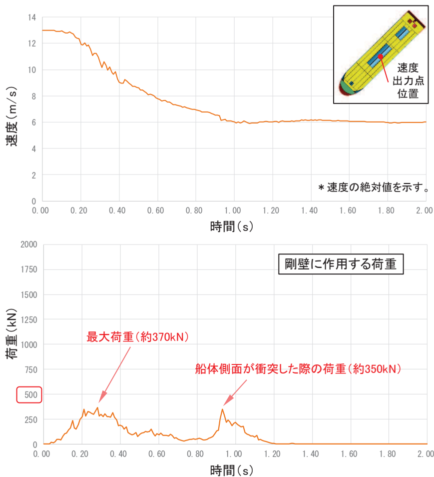
図 1.1 斜め船尾衝突（ケース⑤）の解析結果（上段：速度時刻歴，下段：荷重時刻歴）
