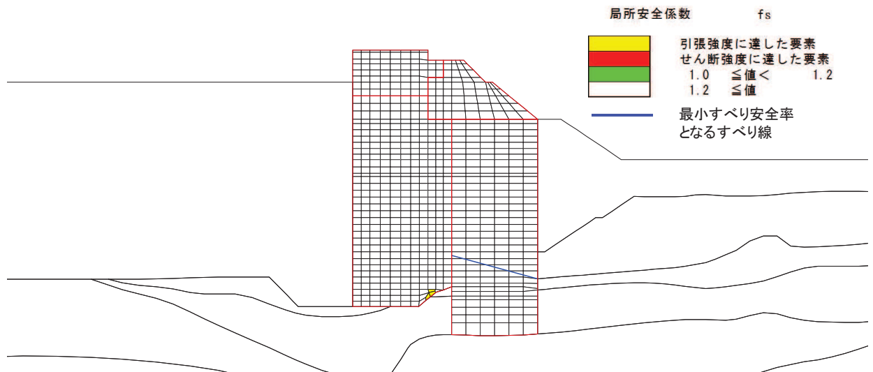
図 3-4 置換コンクリートの最小すべり安全率時刻における局所安全係数分布 (断面①, 短杭, S_s - D2 (---), t=25.49s )
