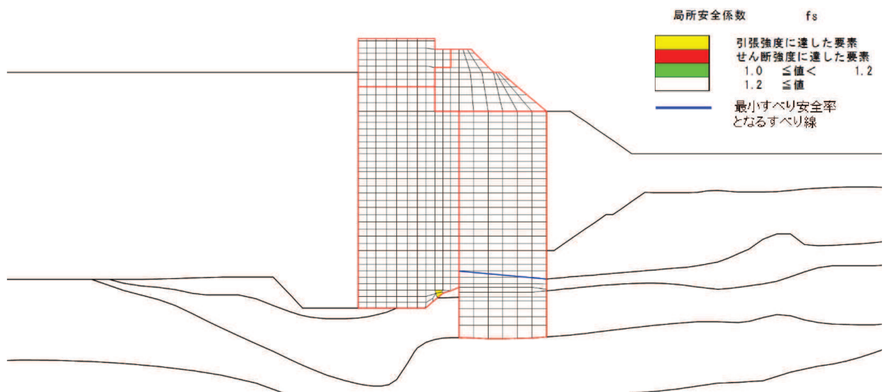
図 5.5-7 置換コンクリートの最小すべり安全率時刻における局所安全係数分布 (断面①, S s - D 2 (—), t=25.49s, 液状化非考慮ケース②)
