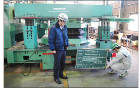
伸び変形後状況
