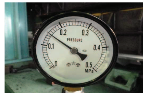
加圧完了 (0.15 MPa, 1 時間保持後, 漏水なし)
