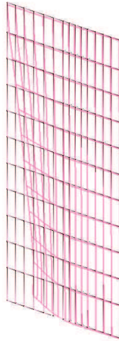
図 7-4(3) 変形図 (重畳時 0.4Sd 水平_1.0Sd 鉛直)
