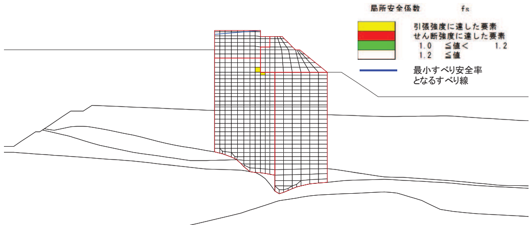
図 4-18 背面補強工の最小すべり安全率時刻における局所安全係数分布 (断面②, S s - D 2 ( - - ) , t=6.91s)
