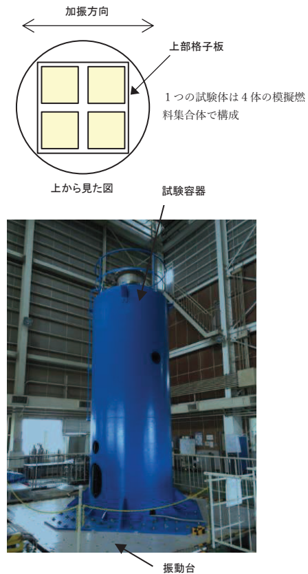
図 12-2 試験装置外観
