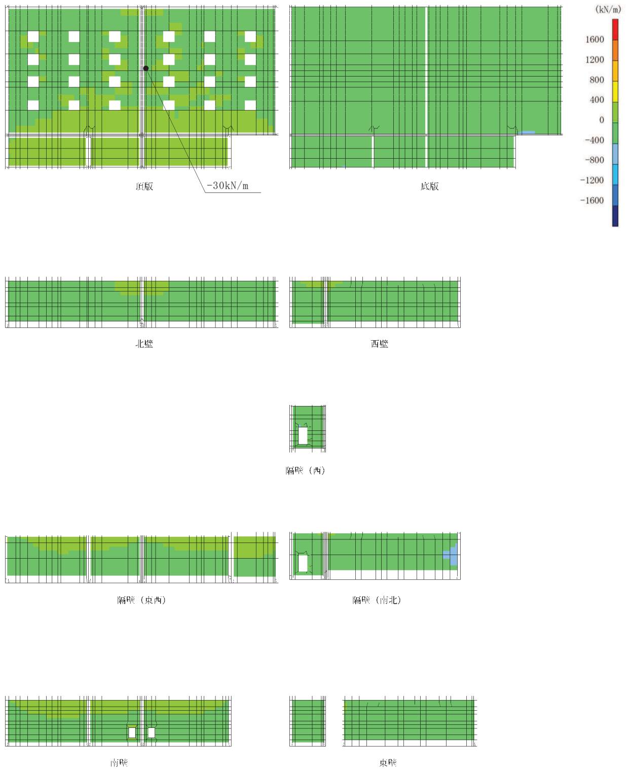
図 10-3 静的地震力載荷時の断面力分布図 (軸力 (kN/m) : N_x )
