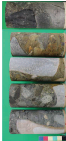
液状化強度試験供試体 (A-7-2 : 試験前)
