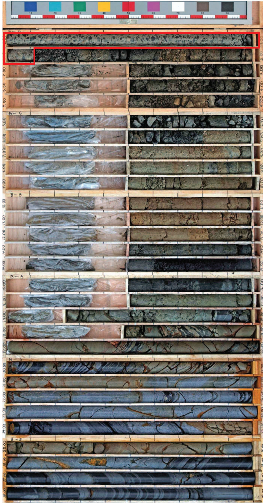
図 1-49(2) ボーリングコア写真 (23B-5) (盛土：深度 0～6.80m, 旧表土：深度 6.80～18.70m)
