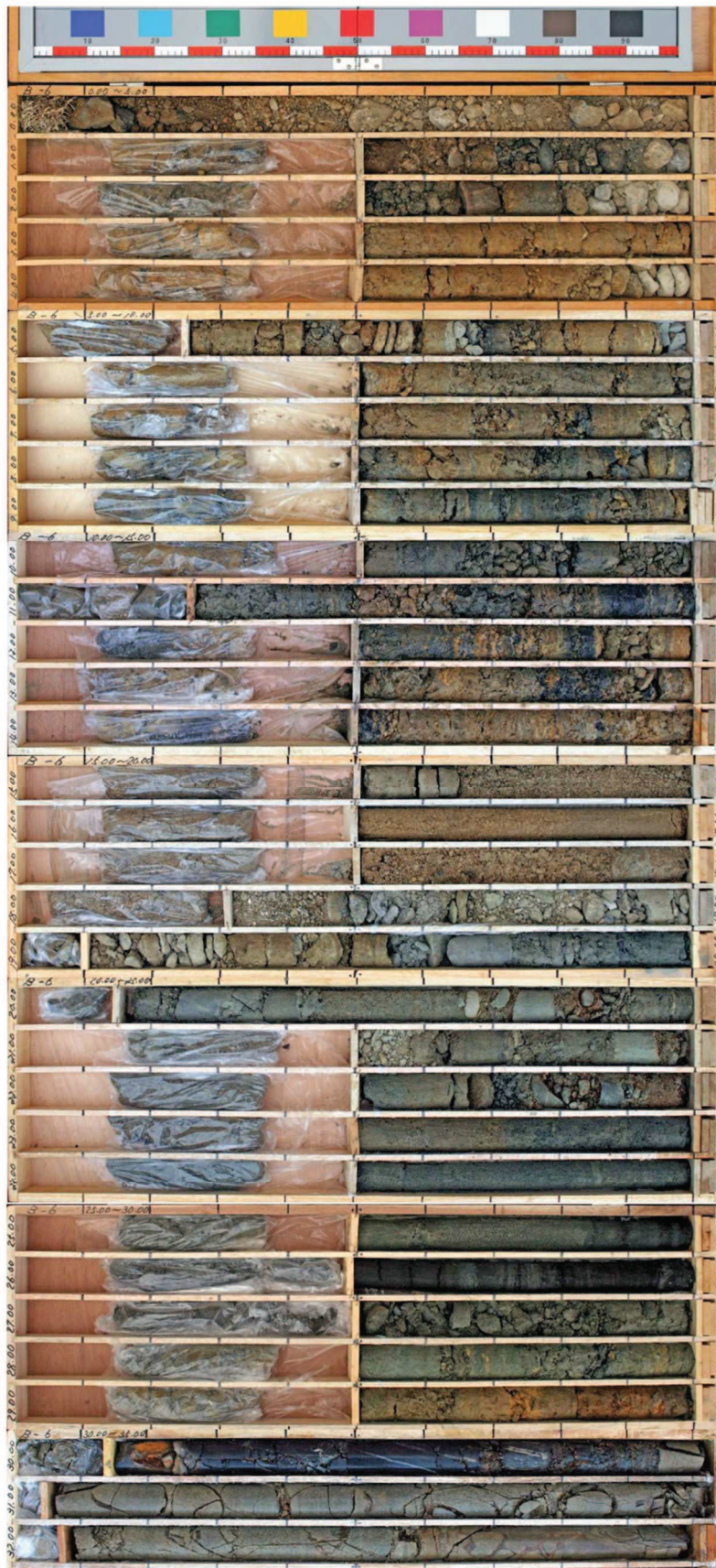
図 1-50(2) ボーリングコア写真 (23B-6) (盛土：深度 0～15.00m, 旧表土：深度 15.00～30.14m)
