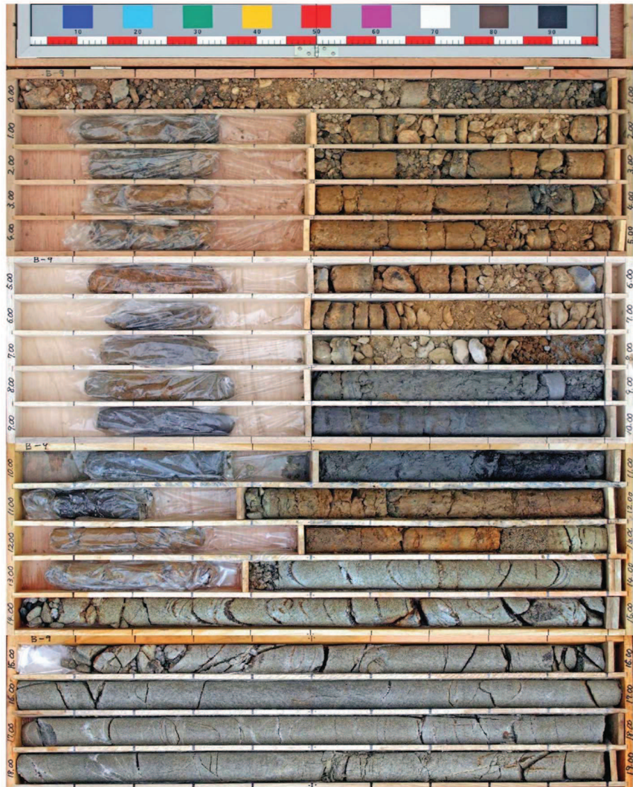
図 1-52(2) ボーリングコア写真 (23B-9) (盛土：深度 0～7.10m, 旧表土：深度 7.10～13.38m)
