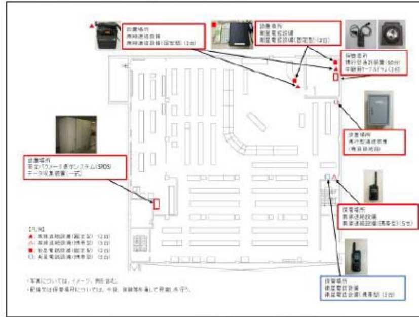
参考第12.1-1図 主要な通信連絡設備の配置図 (制御建屋地上3階 中央制御室及びプロセス計算機室)
