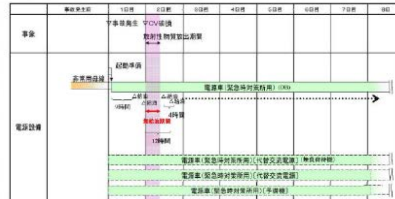
図9 電源車の給油が必要となるタイムチャート
