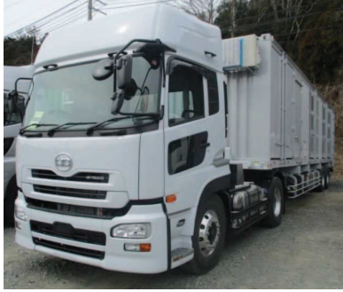
可搬型窒素ガス供給装置
