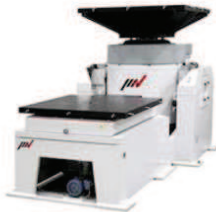
図 5-1 振動台の概要図
