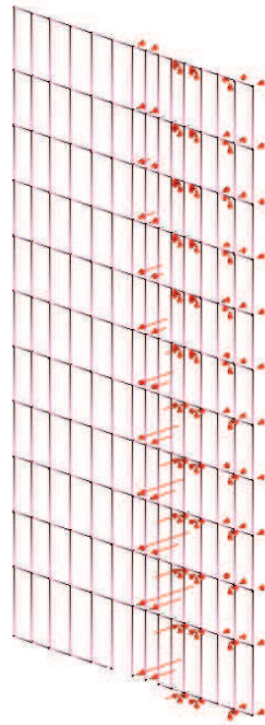
图 7.2-8(2) 反力图 (重叠时 0.4Sd 水平_-1.0Sd 铅直)
