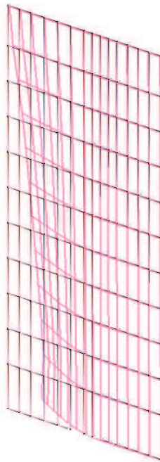
图 7.2-7(2) 反力图 (重叠时 1.0Sd 水平_-0.4Sd 铅直)
