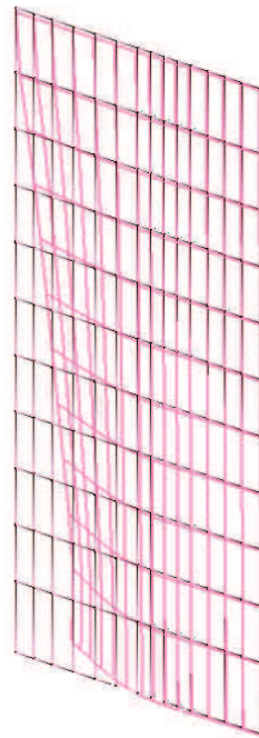
图 7.2-8(3) 变形图 (重叠时 0.4Sd 水平_-1.0Sd 铅直)
