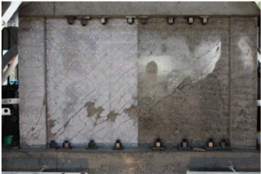
図 3-2 試験体 S-13-D0 最終破壊時写真
