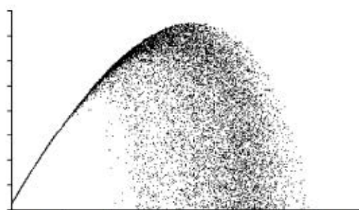
図7-5 直状放射による放水*
