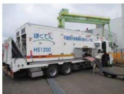
可搬型大容量海水送水ポンプ車の設置
