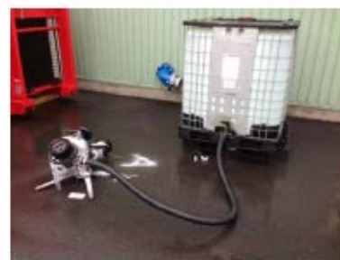
小型放水砲及び泡消火薬剤
