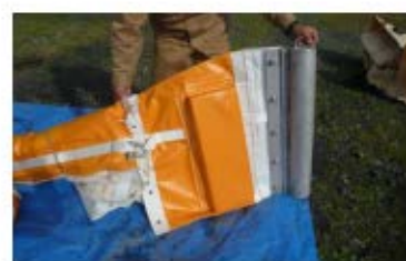
荷揚場シルトフェンス端部
