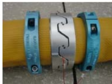
可搬型ホース (150A) 接続後
