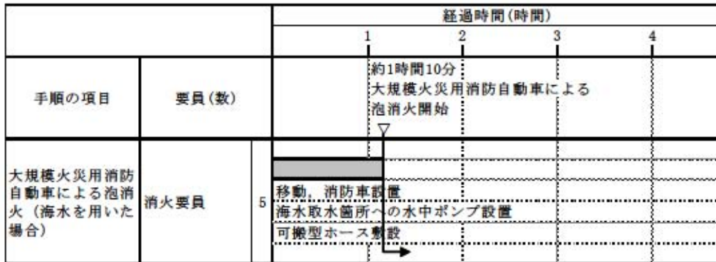
第 1.12.13 図 大規模火災用消防自動車による泡消火 タイムチャート
