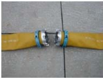
可搬型ホース (150A) 接続口
