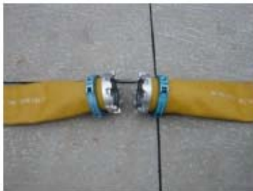
可搬型ホース (150A) 接続口
