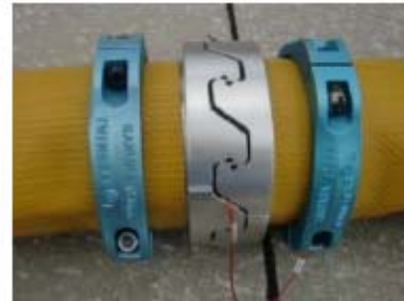
可搬型ホース (150A) 接続後
