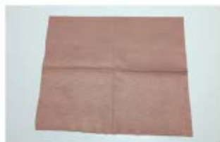
吸着布 （ブリアンプ ® 系類縁体を吸着剤として担持した布）
