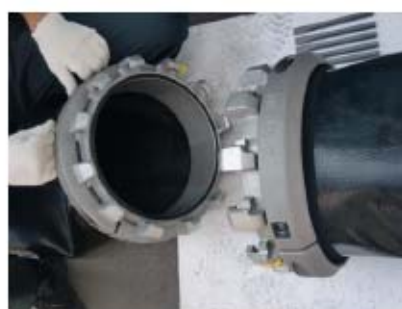
可搬型ホース(300A)接続口
