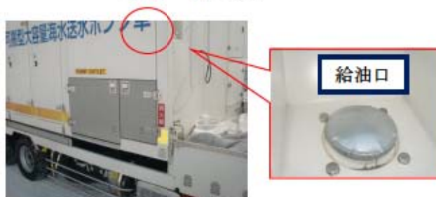
可搬型大容量海水送水ポンプ車への燃料補給
