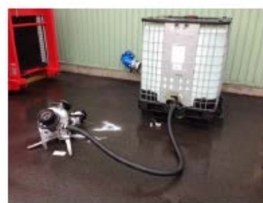
小型放水砲及び泡消火薬剤
