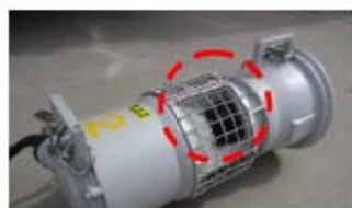
①水中ポンプの吸込み部
