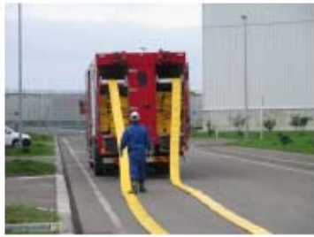
ホース延長・回収車による 可搬型ホース敷設 (屋外 T. P. 10m)
