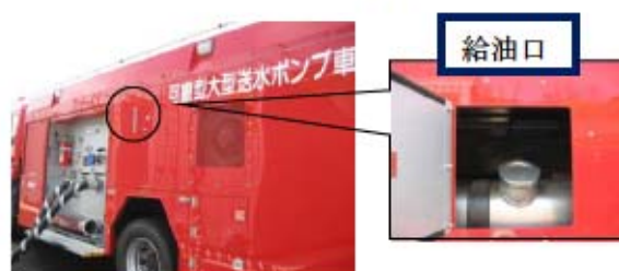
可搬型大型送水ポンプ車への燃料補給
