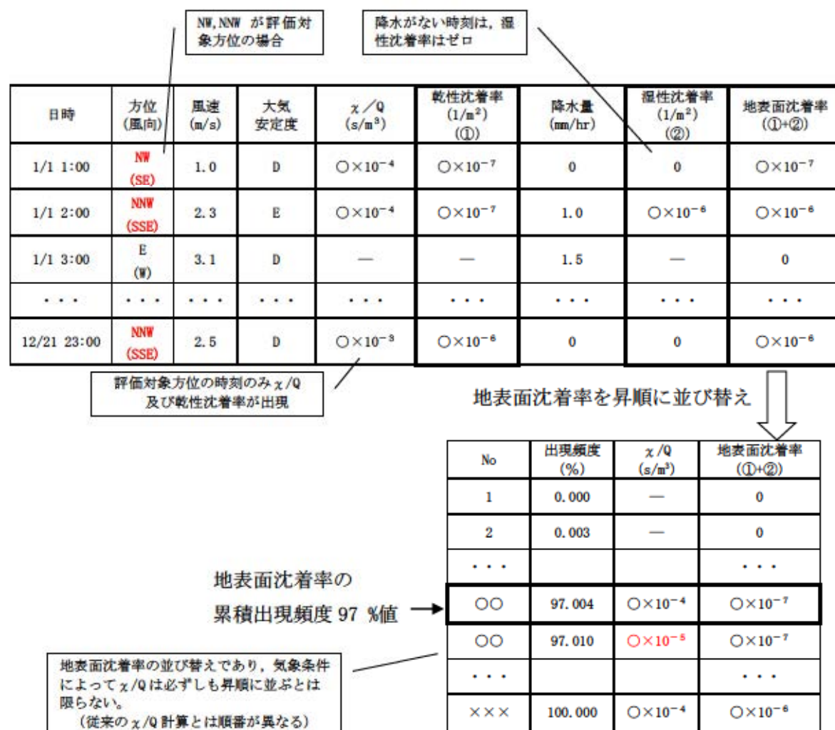
第2図 地表面沈着率の累積出現頻度 97 %値の求め方 (評価対象方位が NW, NNW の例)
