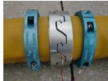
可搬型ホース (150A) 接続後
