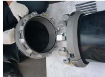
可搬型ホース(300A) 接続口
