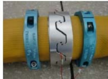
可搬型ホース (150A) 接続後
