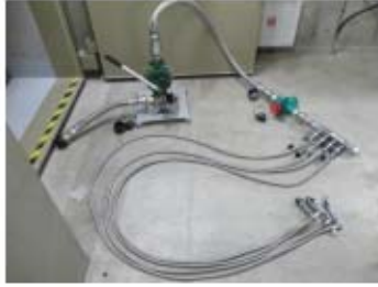
タービン動補助給水ポンプ潤滑油供給器 及び継手類一式 (タービン動補助給水ポンプ室に保管)
