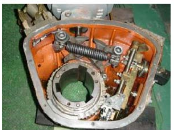
図10 ツインパワー弁駆動部外観及び内部観察
