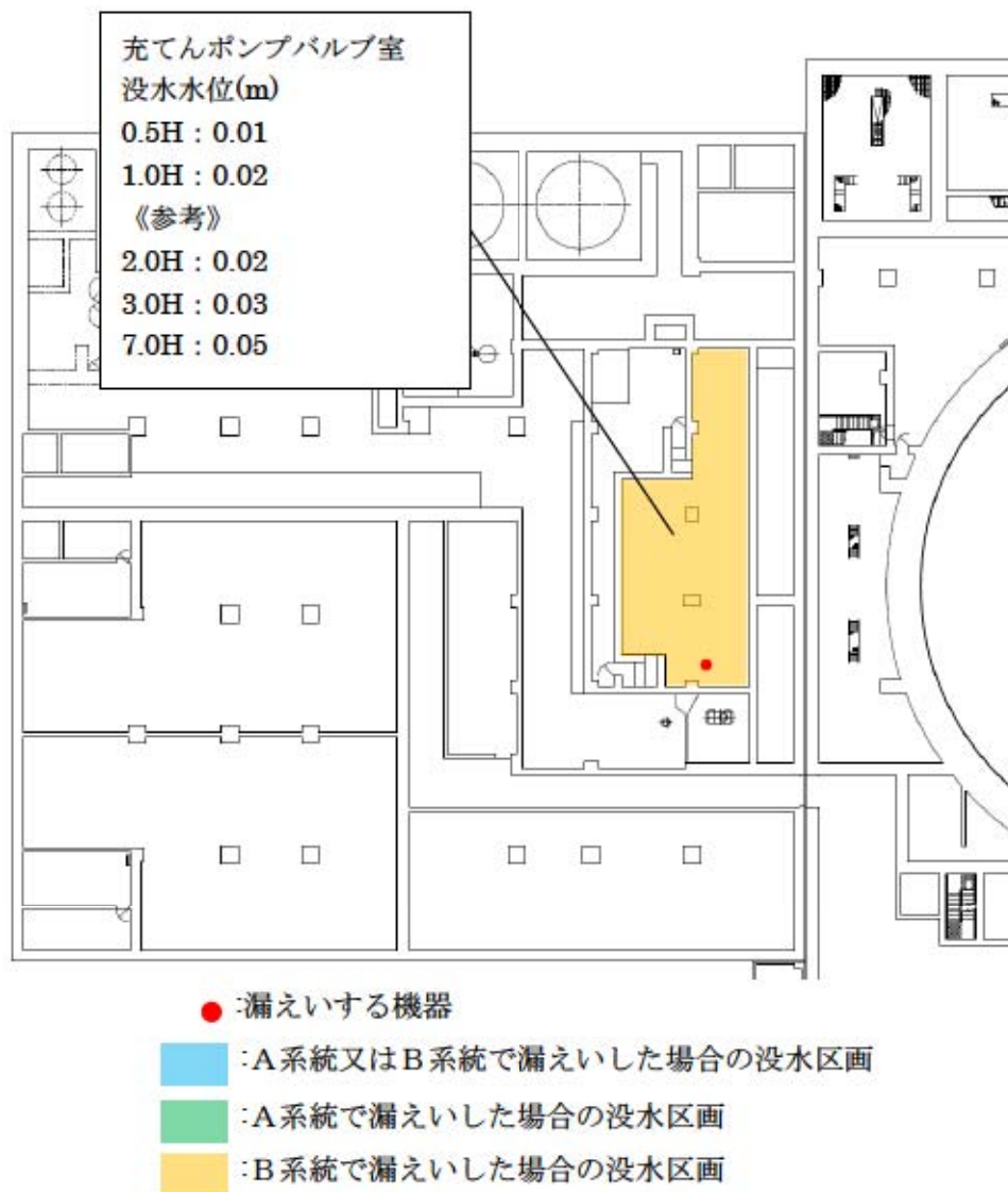
図3 溢水評価 (T. P. 10. 3m 中間床) (ISLOCA が余熱除去系統のB系統で発生)
