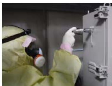
可搬型アンユラス水素濃度計測ユニットの接続 (原子炉建屋 T.P. 24. 8m)
