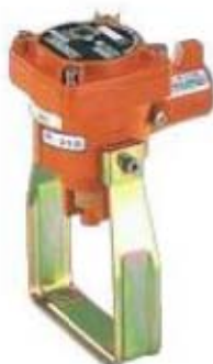
図3 可搬型格納容器内水素濃度計測ユニット検出器(イメージ)
