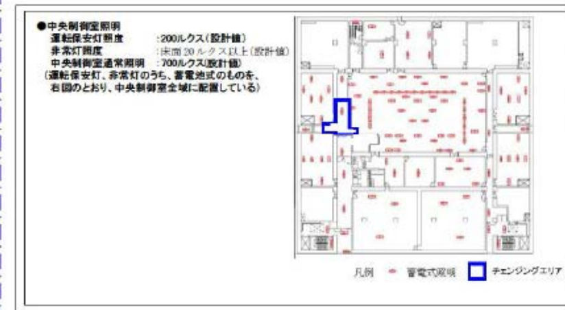
図 4-2 中央制御室照明設備の概要
