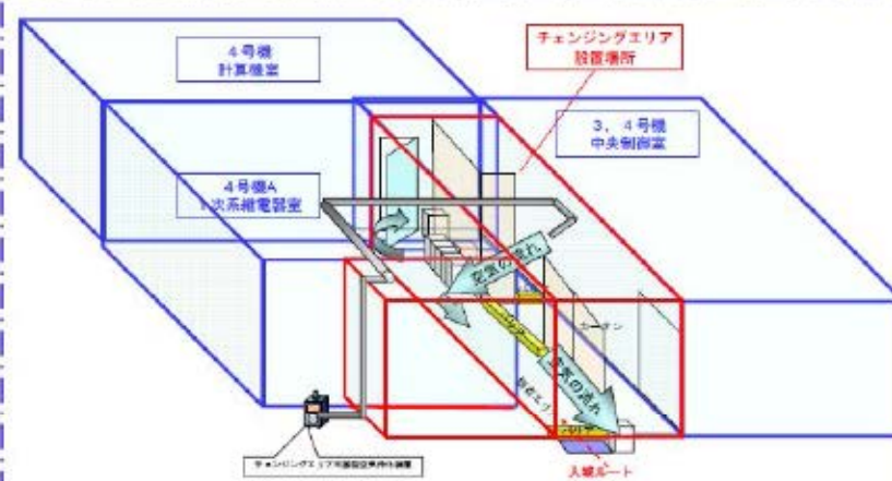
図5-5 チェンジングエリアの空気の流れイメージ図
