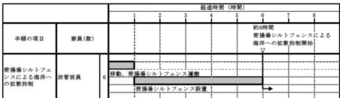
図6 荷揚場シルトフェンスによる海洋への拡散抑制
