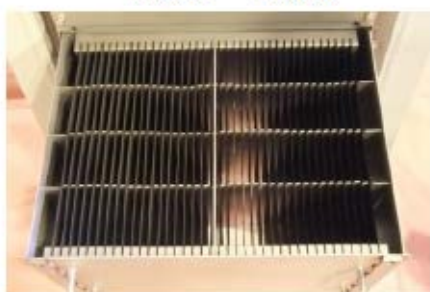
触媒プレート収納部
