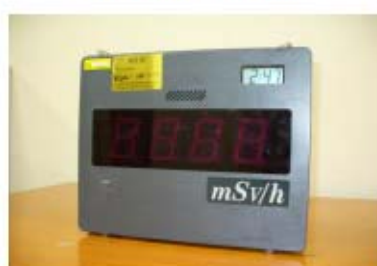
図 1 1 緊急時対策所エリアモニタの外観
