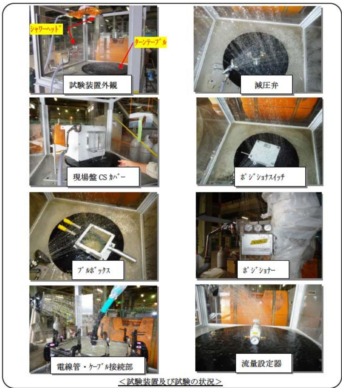
特に現地シール施工部位については、当該モックアップ試験で被水耐性を確認できている施工要領でシール施工を行い、シール施工完了後に社員立会の目視による確認を行っており、適切な施工が実施されていることを確認している。
