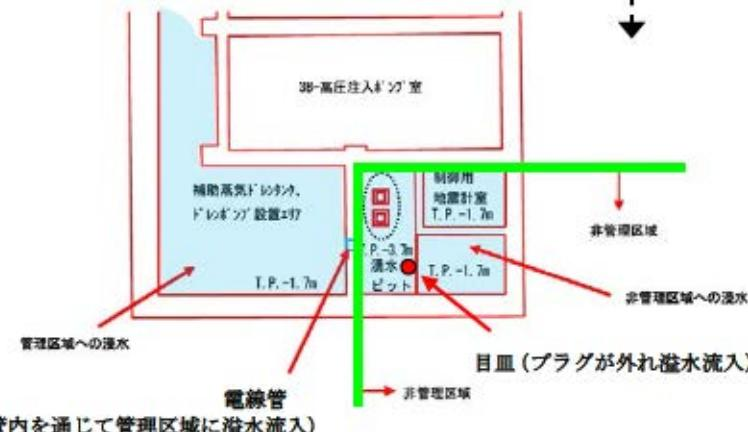
別紙1-図3 T.P. -3.7m 涌水ピット廻り平面図
