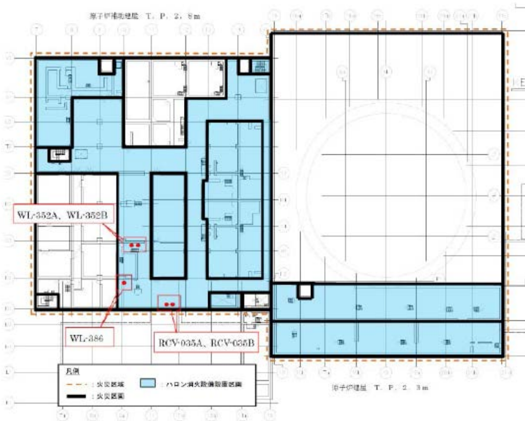
図2 放出ライン空気作動弁設置場所
