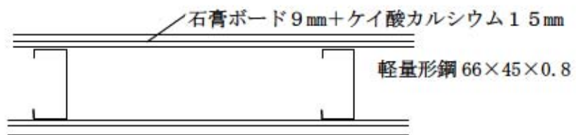
図-2 1時間耐火間仕切壁概要図
