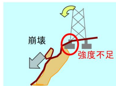
【急傾斜地の崩壊】
