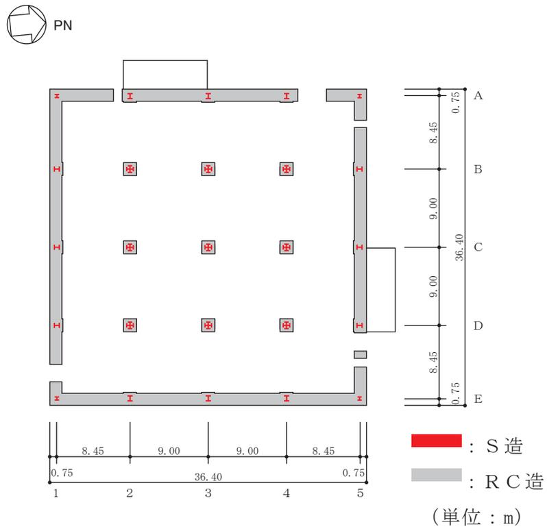
図 2-2(3) 緊急時対策建屋の概略平面図 (0.P.62.2m)
