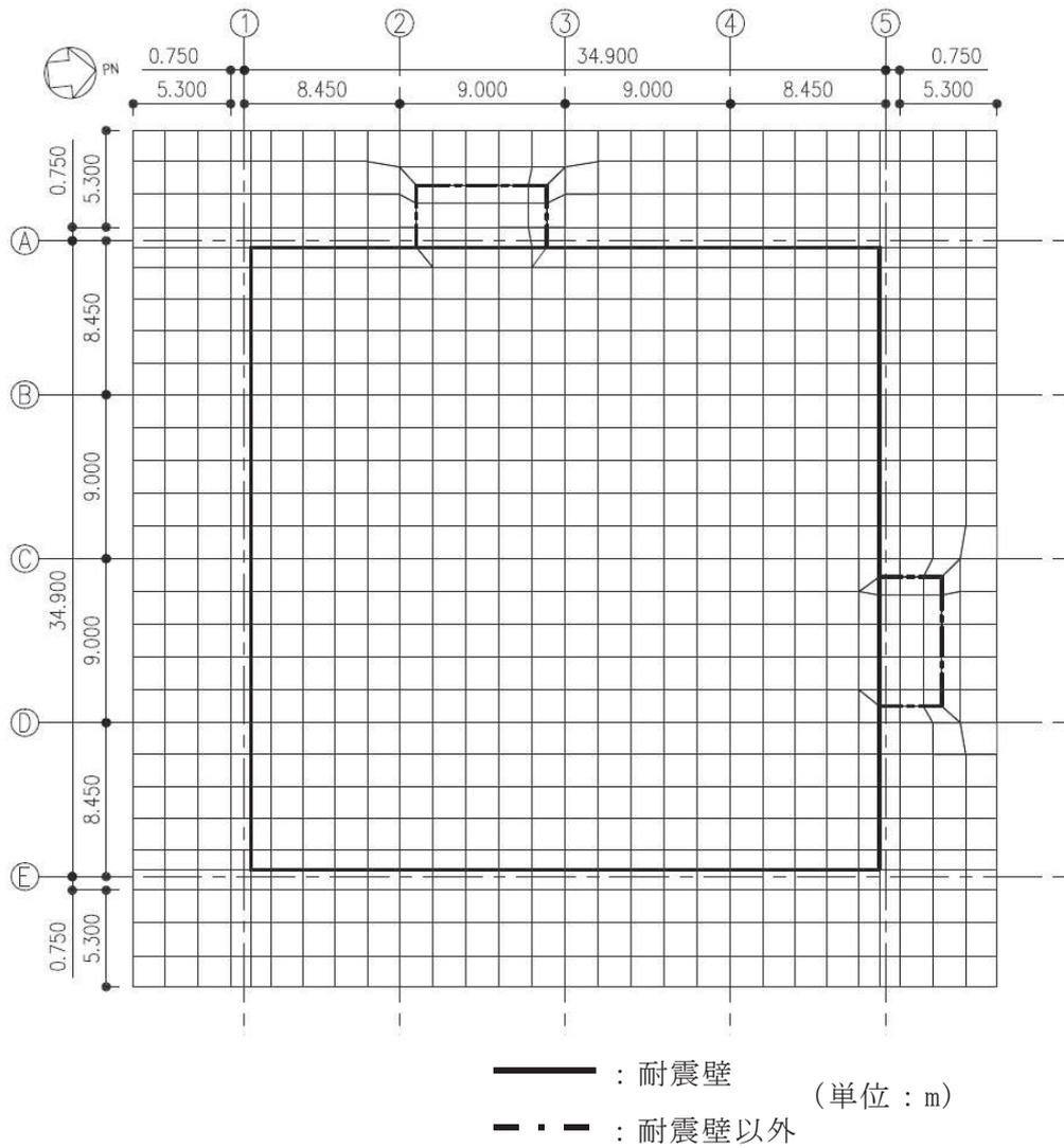
図 4-3 基礎版の解析モデル図
