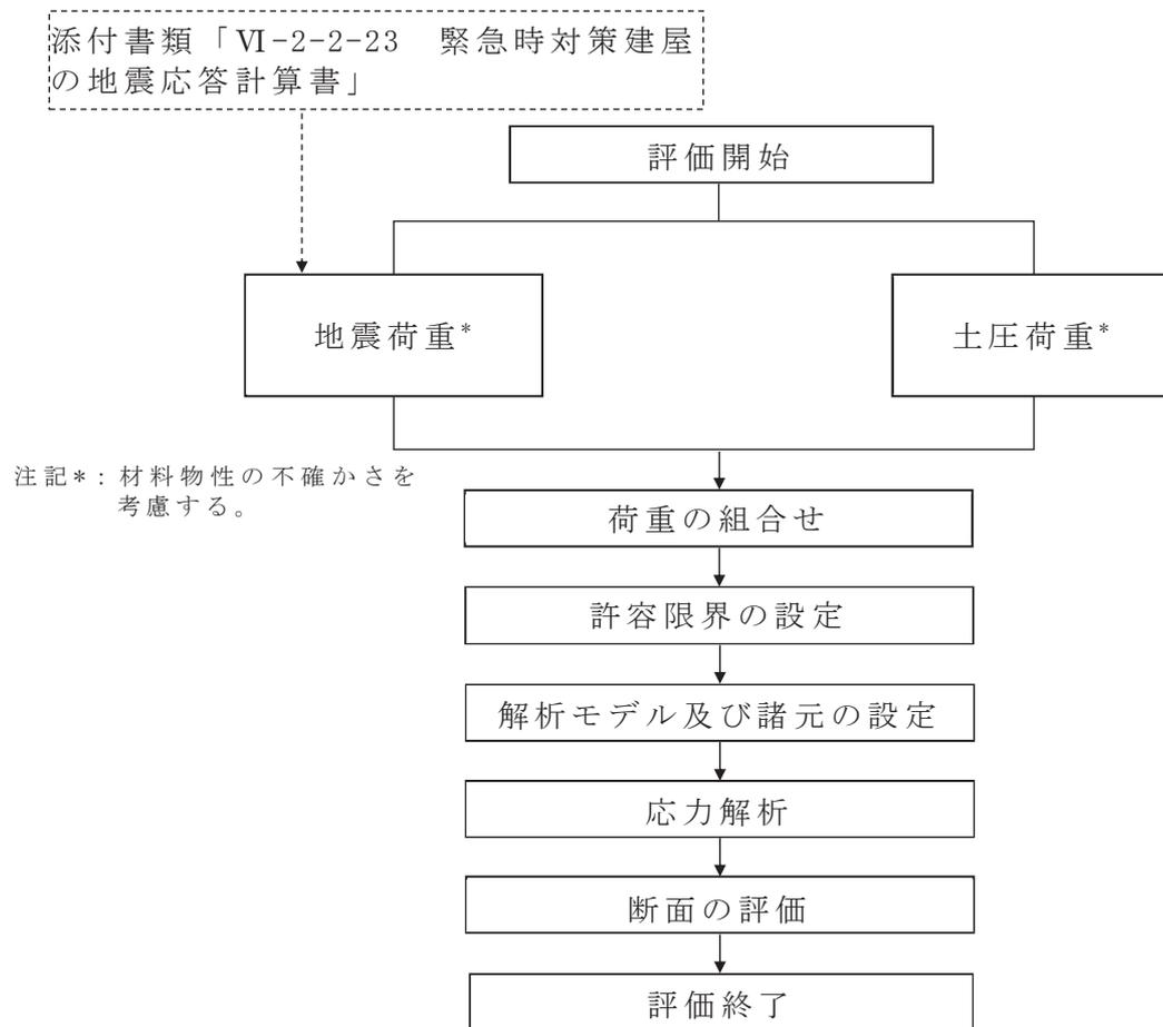
図 3-1 応力解析による評価フロー
