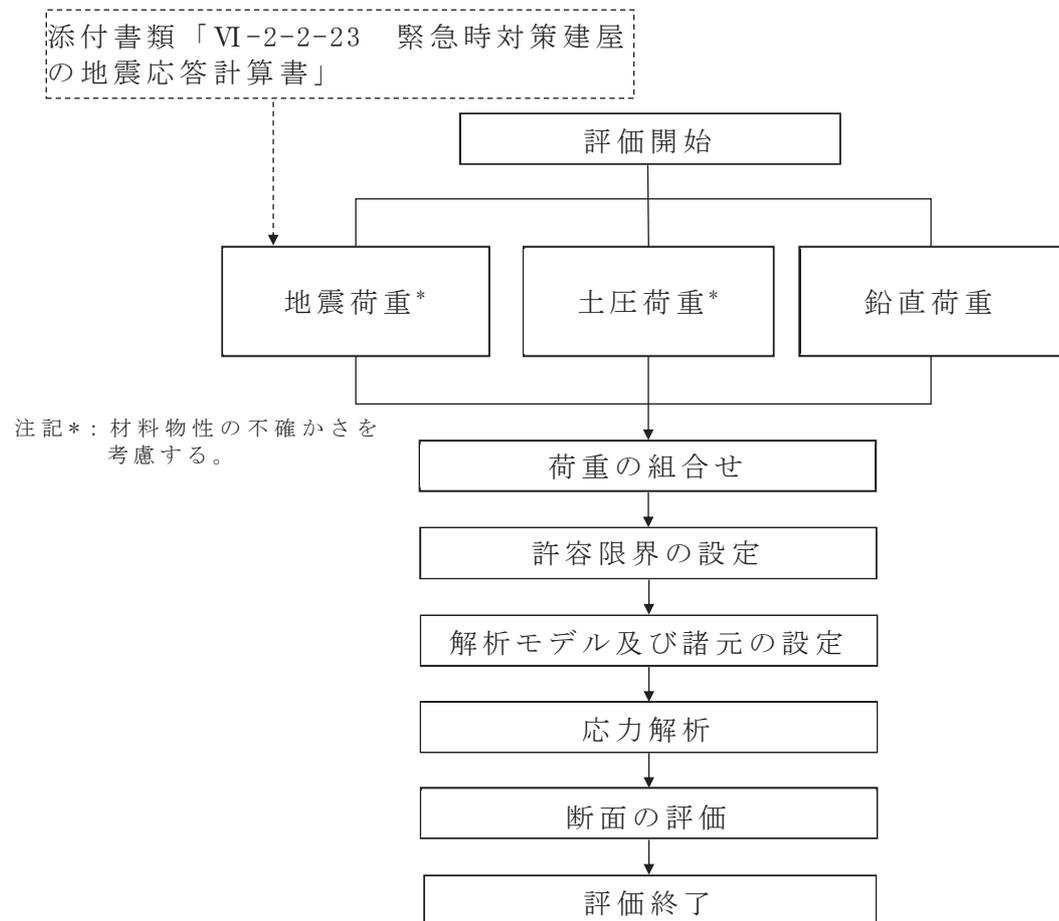
図 4-1 応力解析による評価フロー
