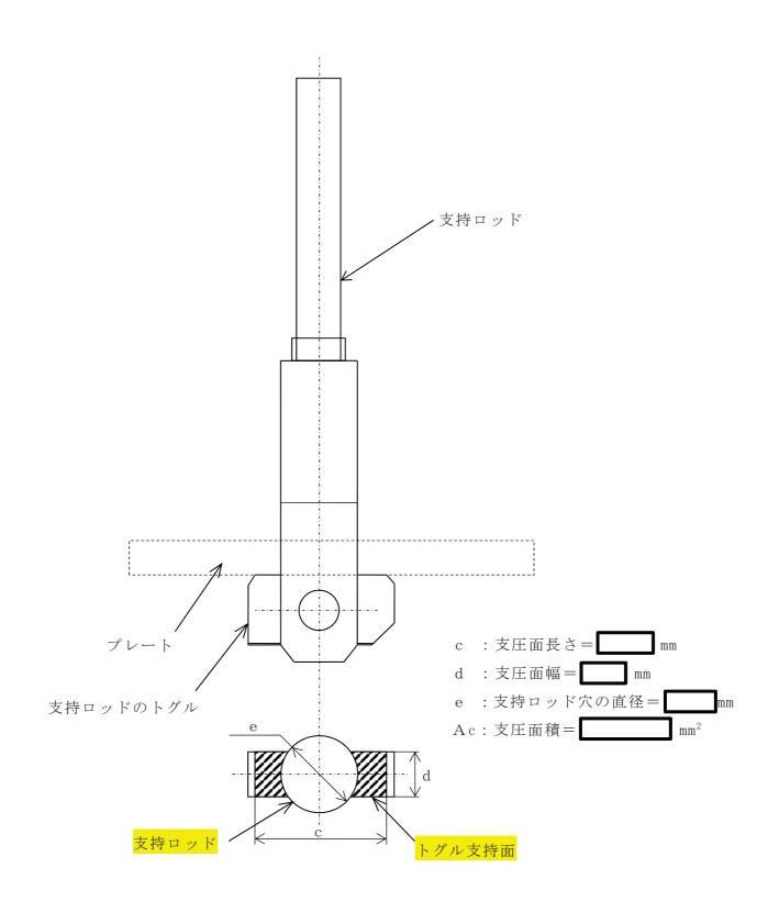
図5-1 支圧荷重の支持面
