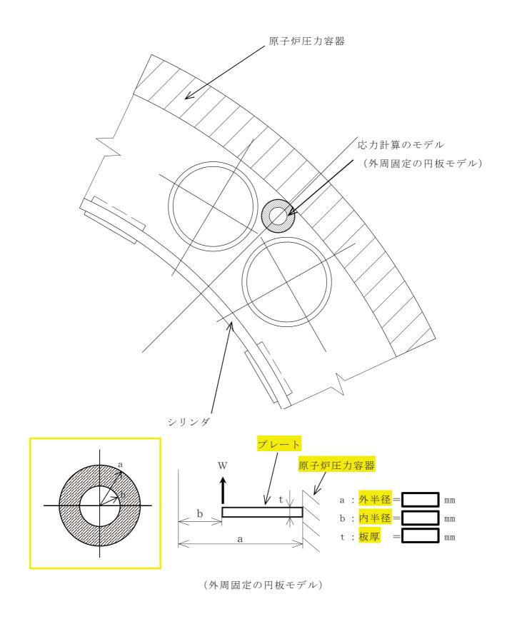
図 3-2 支持ロッドから作用する荷重による応力の計算モデル
