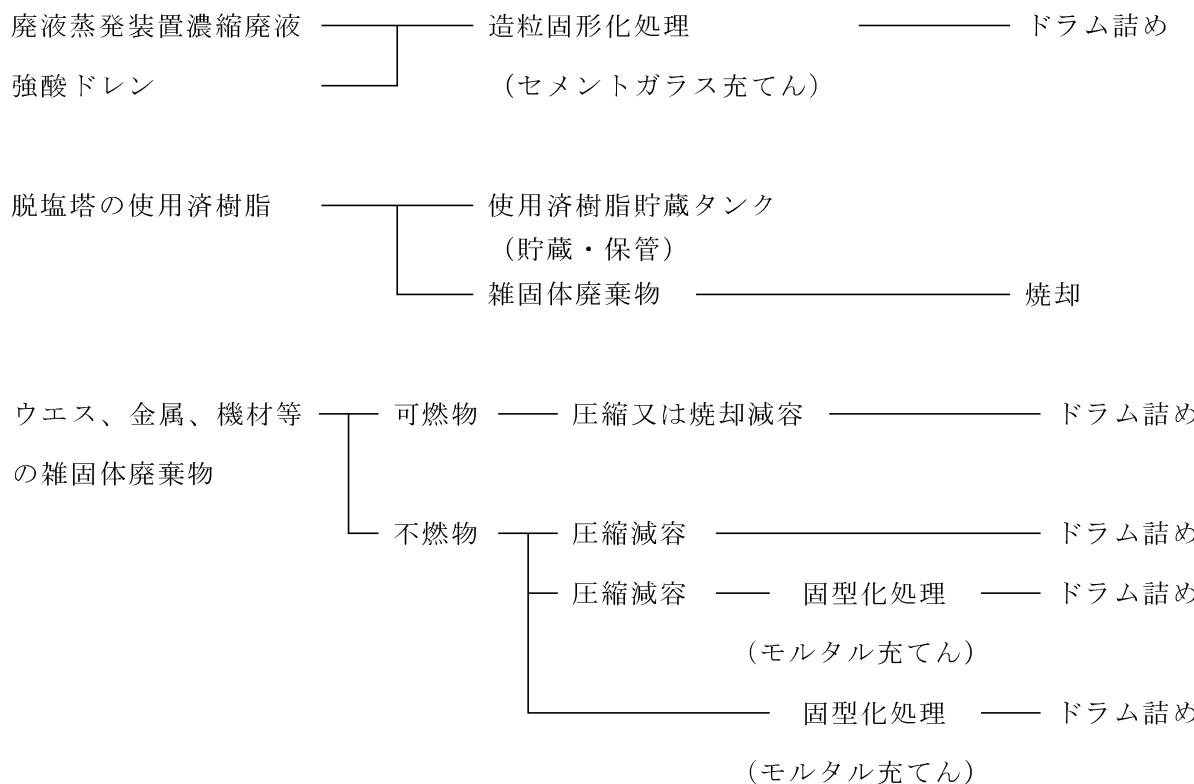
固体廃棄物処理設備は、廃棄物の圧縮、焼却、固化等の処理を行う過程において放射性物質が飛散しないような措置を講じている。また、この設備からの排ガスはフィルタを通して、モニタによって監視しながら排気筒より放出する。
