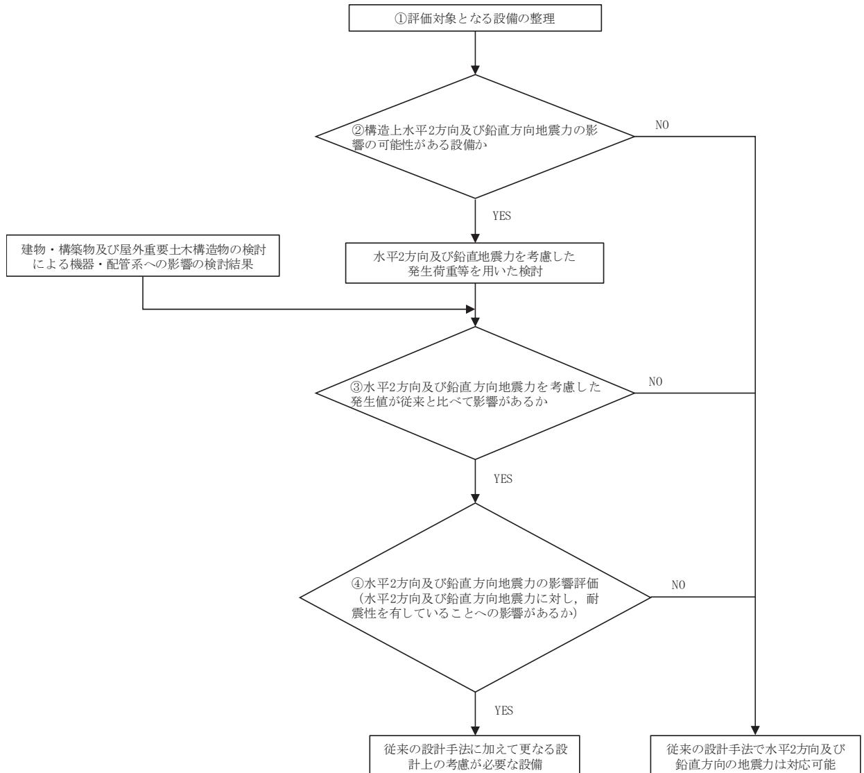
図 2-1 水平2方向及び鉛直方向地震力の組合せを考慮した影響評価フロー
