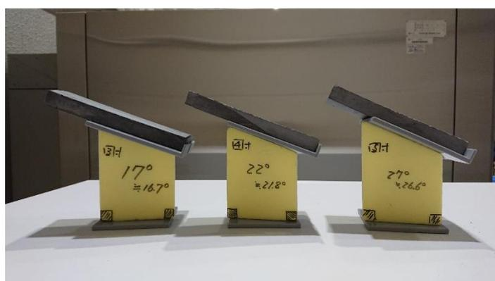
図 3.5 屋根の傾き(左から瓦 3 寸、瓦 4 寸、瓦 5 寸)
