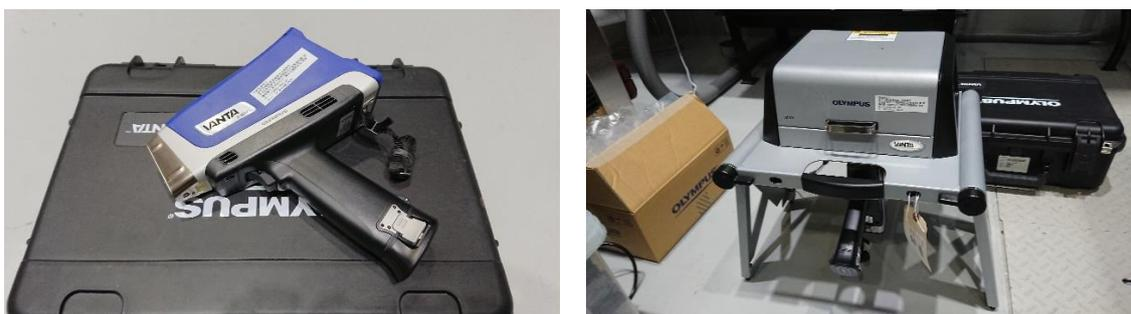
図3.7 VANTA(左:VANTA本体、右:VANTAとワークステーションの組み合わせ)
