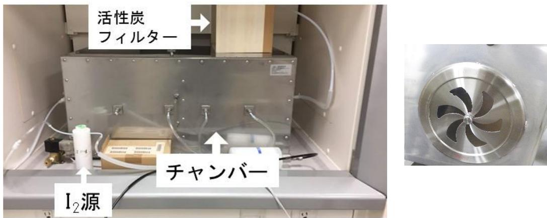
図 2.2 実験チャンバー（左）と試験体（右）の写真
