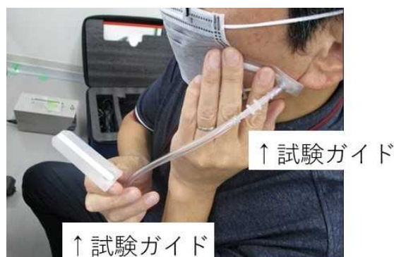
図 2.17 漏れ率の測定状況
