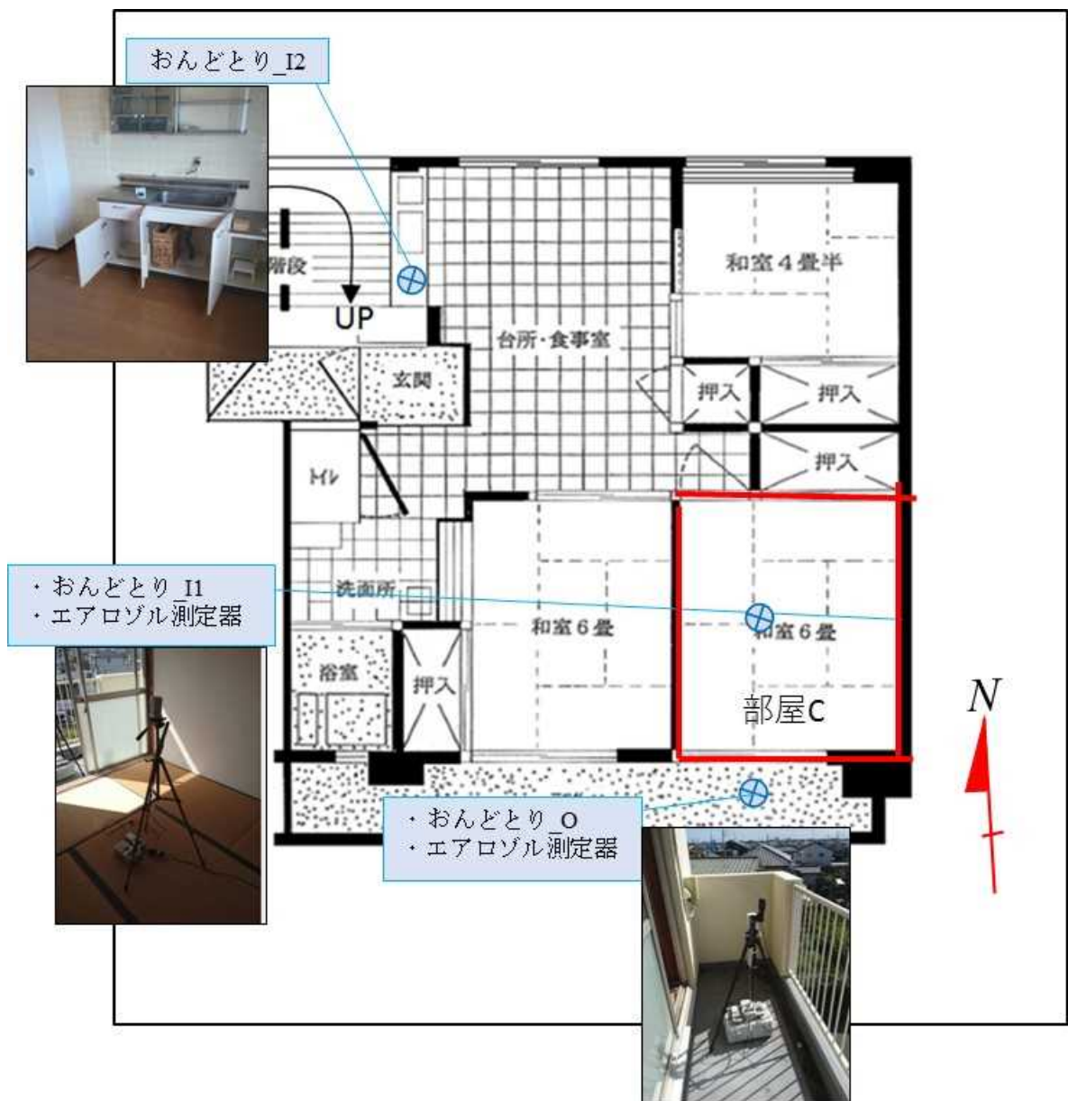
付録図 3.5 実験対象家屋の間取り図と測定機器の配置 (集合 C)
