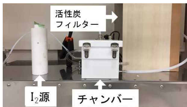
図 3.9 I 2 の沈着率を求めるためのチャンバーの写真
