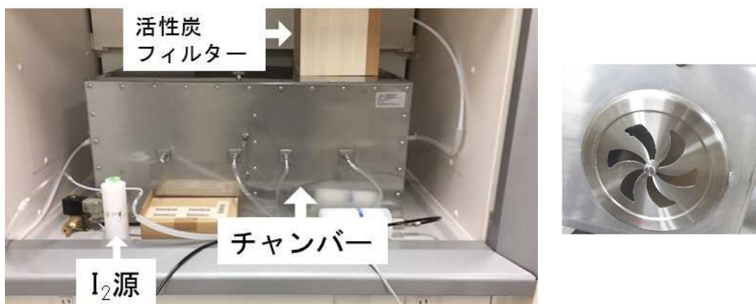
図 3.12 \text{I}_2 の浸透率を求めるためのチャンバー（左）と試験体（右）の写真
