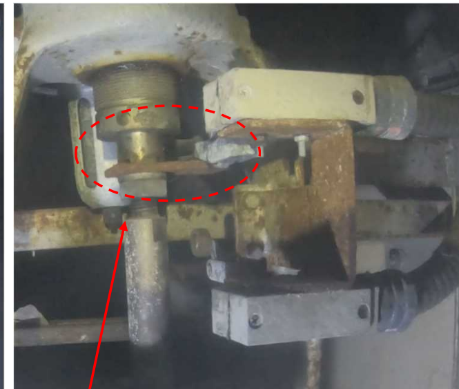
リミットスイッチ部の拡大 リミットスイッチの位置:上側
