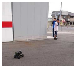
CR警報器をクローラーに設置 リモート会議のアプリを同時起動させ、現場の状況を伝送
