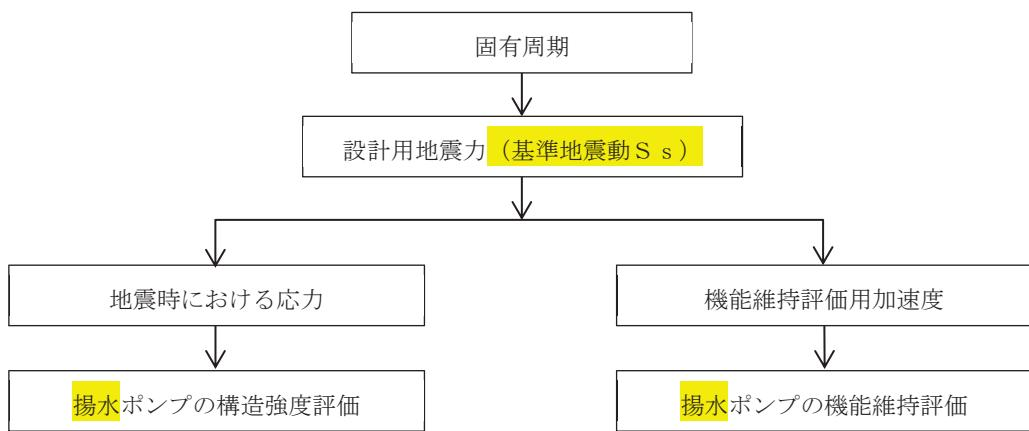
図 2-1 揚水ポンプの耐震評価フロー
